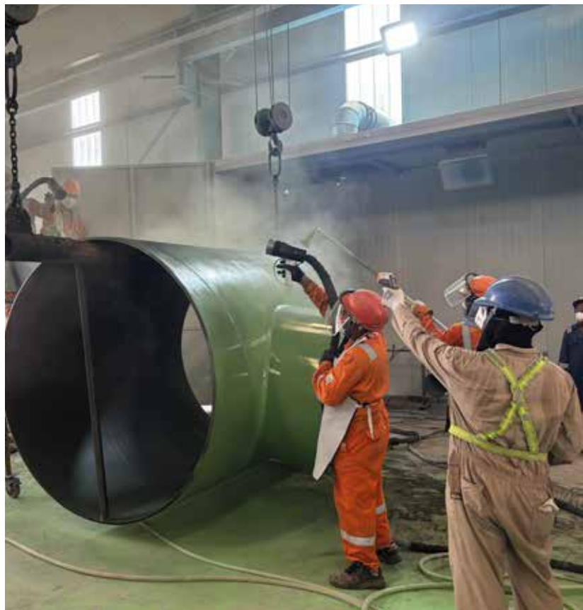
Strato adesivo: applicazione simultanea di FBE e PE.
